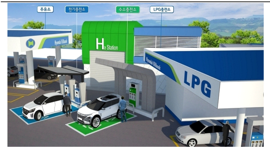
[그림 4-16] LPG 충전소에 수소차 충전소 설치 개념도
