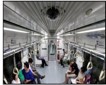
도시철도 CCTV 설치
