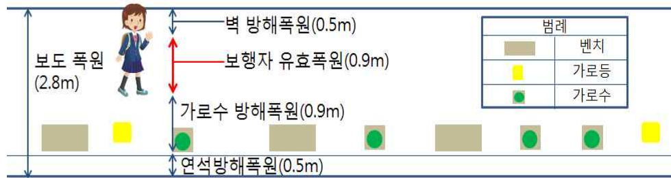
<그림 4-2> 3-서측 구간 장애물 및 유효폭원(국토해양부 기준)
