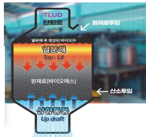
[그림 3-16] 유기산업의 바이오차 생산시설 및 TLUD 공정과정
