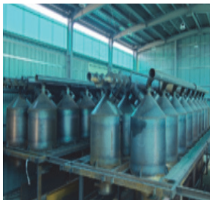
[그림 3-16] 유기산업의 바이오차 생산시설 및 TLUD 공정과정
