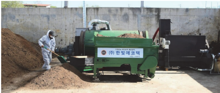
[그림 3-10] (주)한빛에코텍 소형 바이오차 생산 기계 예시
