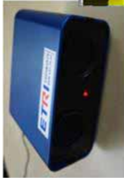
Z-cube(Active type Depth Sensor) - 실내용 3차원 깊이 정보 획득 장치
