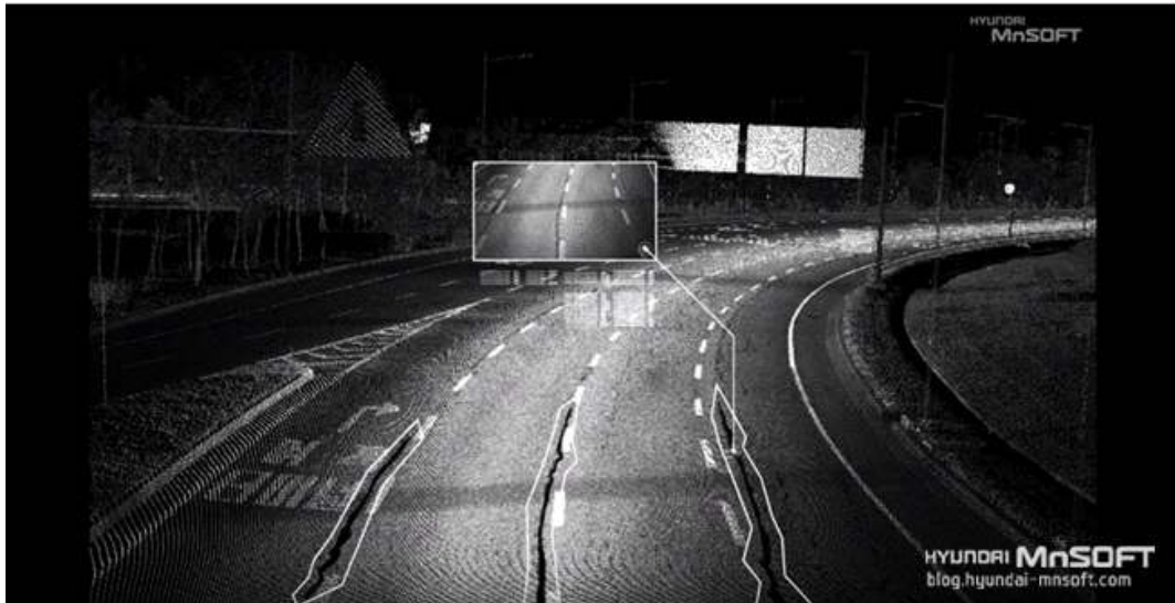
[그림 6-13] MMS장비를 활용한 포장상태 모니터링
