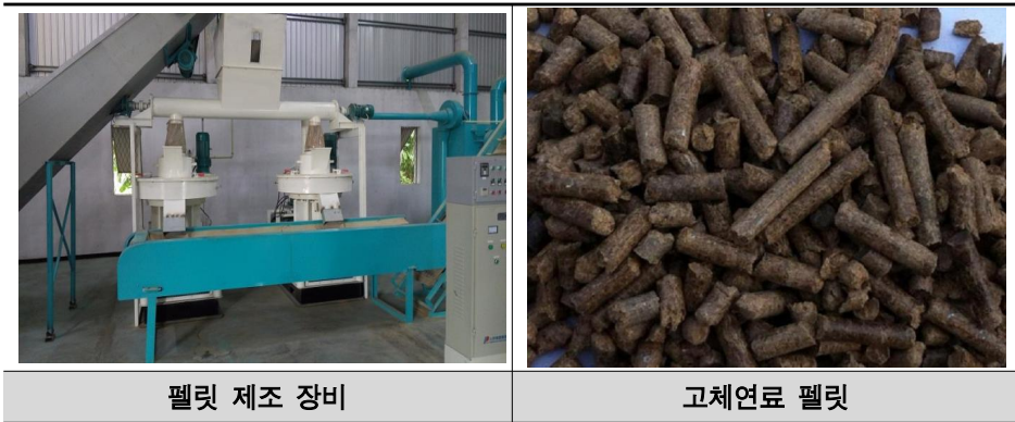
[그림 3-26] 중국의 가축분뇨 고체연료 제조장치
