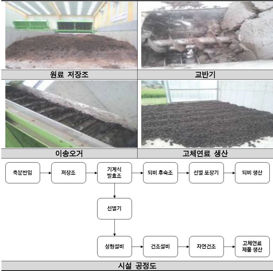
[그림 3-24] 포천시 가축분뇨 고체연료화 시설 및 공정도
