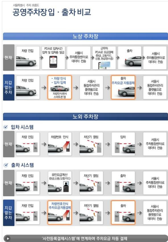
[그림 3-5] 서울시 ‘지갑 없는 자동결제 주차장’ 시스템 출처 : 서울시 120다산콜센터 공식 블로그
