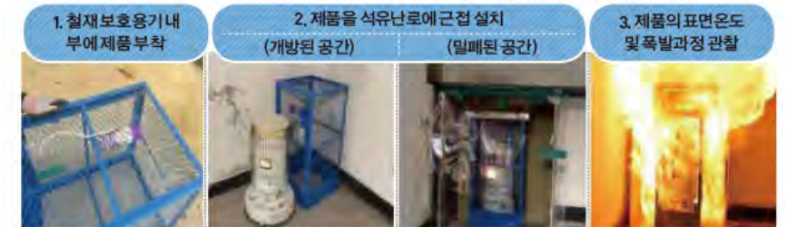
사진 2 난로 주변에 에어로졸 제품 비치 후 폭발 시험과정
