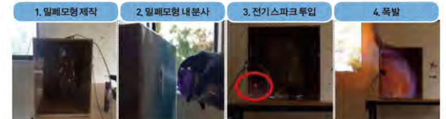
사진 1 인접 기계 스파크 발생으로 인한 에어로졸 제품 화재 사고 시험과정
