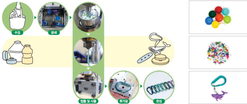
[그림 3-10] 프레스스 플라스틱 제품 제작 과정
