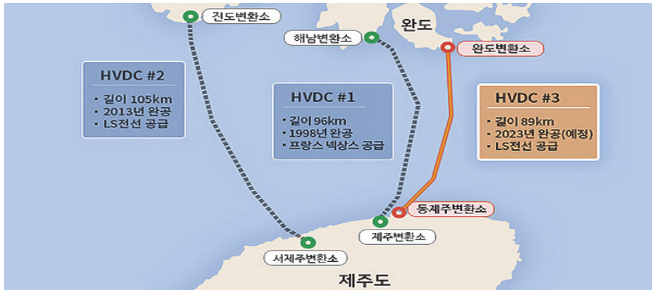
[그림 4-16] 제주도 초고압직류송전(HVDC)
