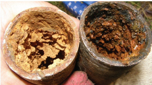
<그림4. 이온수처리에 의한 관내 스케일 및 녹 변화>
