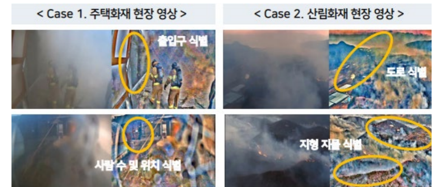
그림 5. 현장에서 촬영된 영상에 영상처리 기술을 적용한 결과
